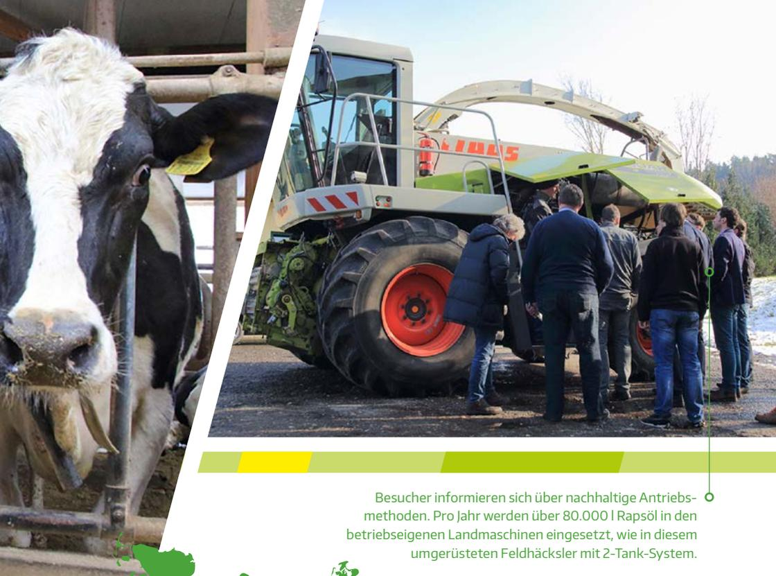
Besucher informieren sich über nachhaltige Antriebsmethoden. Pro Jahr werden über 80.000 l Rapsöl in den betriebseigenen Landmaschinen eingesetzt, wie in diesem umgerüsteten Feldhäcksler mit 2-Tank-System.
