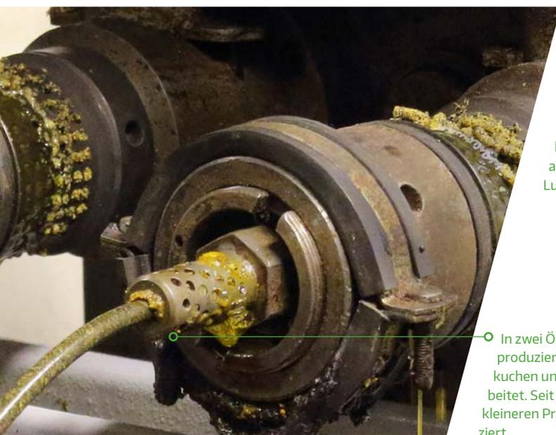
○ In zwei Ölpresen wird ein Teil der produzierten Rapsaat zu Rapspresskuchen und Rapsölkraftstoff verarbeitet. Seit 2017 wird in einer weiteren, kleineren Presse Rapspeiseöl produziert.
