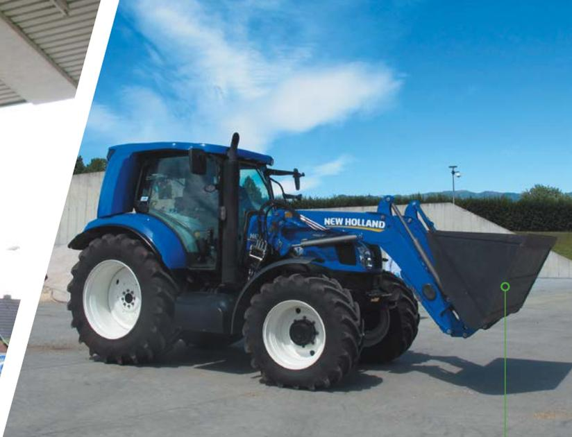
Der Biomethan-Traktor des Herstellers New Holland, Modell T6.180, hat einen FPT6-Zylinder-Motor mit 6,75l Hubraum und 179PS. Eine aufwendige Abgas-Nachbehandlung ist bei Methan-Traktoren nicht notwendig. Abgesehen vom Antrieb ist der T6.180 ein Standard-Traktor, der keine speziellen Getriebe- oder Hydraulikkomponenten benötigt.
