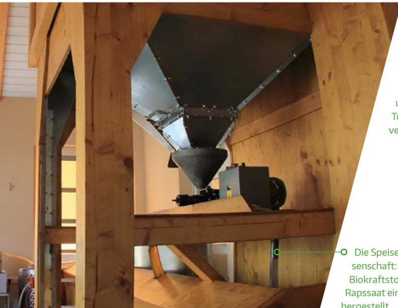
○ Die Speiseölmühle der Agrargenossenschaft: Neben der Nutzung als Biokraftstoff wird aus der eigenen Rapssaat ein hochwertiges Speiseöl hergestellt.
