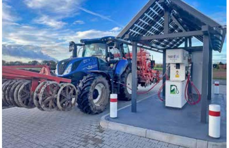
*Kraftstoff aus Pferdemit: Daniel Königs aus Neuss beschickt inzwischen seine Biogasanlage zu mindestens 60 % mit Pferdemit von umliegenden Gestü- ten. Seit 2023 kann das aufbereitete Biomethan in Form von BioCNG nicht nur von den betrieblichen Schleppern, sondern auch von passierenden Lkw-Flot- ten getankt werden.*
